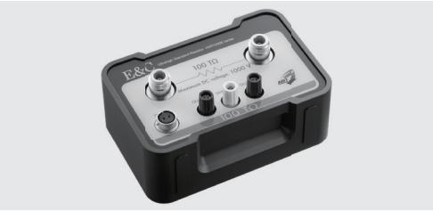
HVR10000シリーズは、超高抵抗値領域で低温度係数および低電圧係数を実現した高安定な標準抵抗器です。抵抗回路の接続端子にはガードを備えており、気中で安定した抵抗値測定が可能となります。温度センサを備えており、抵抗器の内部温度測定が可能となります。25 °C ± 10 °Cの環境下で、精密な抵抗値測定を行うことが可能となるため、計測器の校正用としても利用が可能です。
